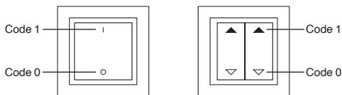
Die ALADIN-Wandsender gehören zum ALADIN-Funksystem. Mit einem Tastendruck auf den batterielosen und wartungsfreien Wandsender können Verbraucher drahtlos mit den ALADIN-Empfängern geschaltet werden. Beim Drücken (und Loslassen) der Wippe des Wandsenders wird über einen Bügel ein Energiewandler zur Energieerzeugung betätigt. Jeder Sender verfügt über eine einmalige Identifikations-Adresse.
